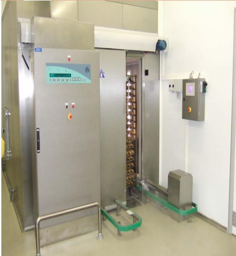
L'abbattitore grazie a un potente sistema di refrigerazione con aria fredda forzata a ca.  $-10^{\circ}\text{C}$  o  $-40^{\circ}\text{C}$ , consente di raggiungere  $-1^{\circ}\text{C}$  al cuore del prodotto entro 60' (soft chiller) oppure  $-18^{\circ}\text{C}$  entro 120' (hard chiller).
